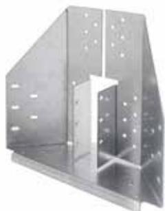
El ETC392 es el último producto desarrollado en la gama de los estribos para faldones. Permite realizar faldones mediante la unión de las semi-armaduras de la limatesa y el cabrio corto. Fue especialmente diseñado para la fijación sobre cercha industrial con soporte de 97 mm como mínimo.
