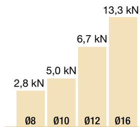
Valores de cálculo de tracción BOAX - hormigón C20/25
