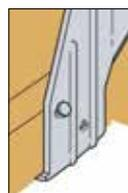
Puede aumentarse la carga al levantamiento clavando dos puntas a 45° en el ala inferior.
