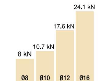
Valores de cálculo de tracción - hormigón C20/25
